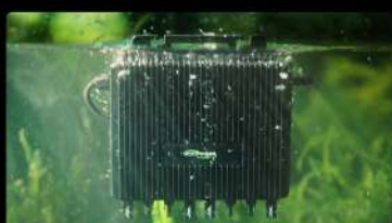
Test d'immersion dans l'eau
