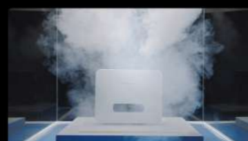
Test au brouillard salin
