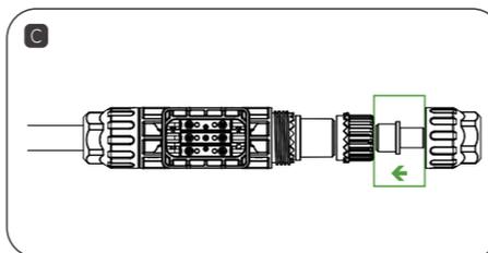
Installez un bouchon d'extrémité de bus de jonction en T à l'extrémité de la jonction en T.
