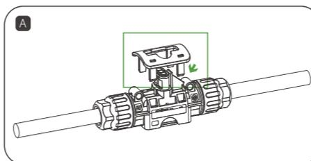
Utilisez l'outil de retrait du raccord en T pour retirer le couvercle inférieur.
