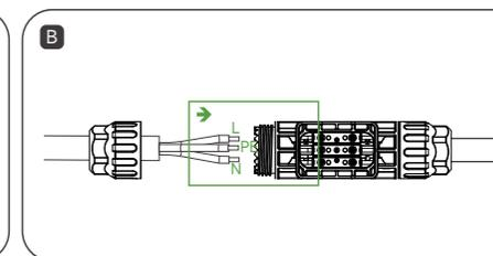
Insérez le câble CA dans le connecteur de jonction en T à la position correcte du trou.
