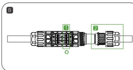
Desserrez la vis intérieure, dévissez l'écrou et retirez le câble.
