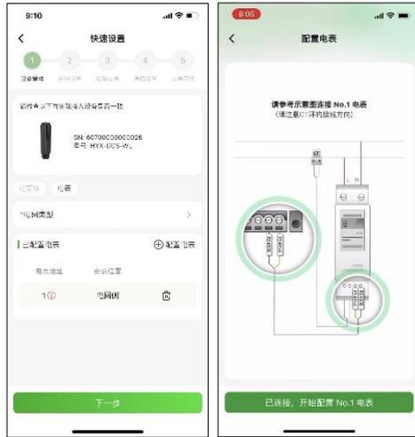
输入电表原始地址位，连接485线，选择安装位置进行电表配置
